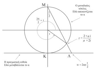
Εύχολοι υπολογισμοί στο τρίγωνο ΚΛΜ μας δείχνουν ότι  $\overline{\text{KM}}\overline{\Lambda}=\frac{t}{2}$  και επομένως η εικόνα του z έχει συντεταγμένες  $\sigma v \nu \left(\frac{3\pi}{2}+t\right)$  και  $\eta \mu \left(\frac{3\pi}{2}+t\right)$  δηλαδή  $\eta \mu t, -\sigma v \nu t$ . Για να βρούμε που αντιστοιχεί το  $\alpha$  το τοποθετούμε στον άξονα αποκτούμε το  $\Lambda$  το οποίο και ενώνουμε με το M. Το σημείο όπου η  $\Lambda M$  θα τμήσει τον χύχλο είναι η εικόνα του z.
